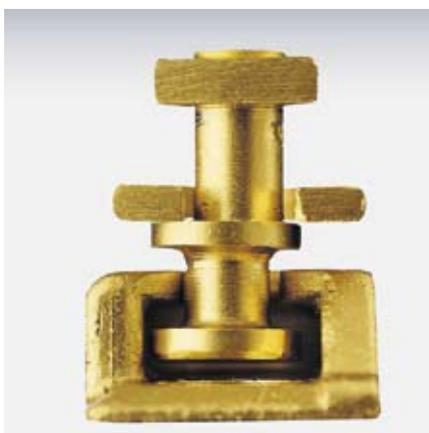
**Nottolino a fungo e relativo scontro.** Il nottolino oltre ad inserirsi nello scontro, si assicura a questo con una testa (fungo) vanificando quindi la possibilità di estrarlo con una semplice leva. I nottolini a fungo sono regolabili come quelli normali.
