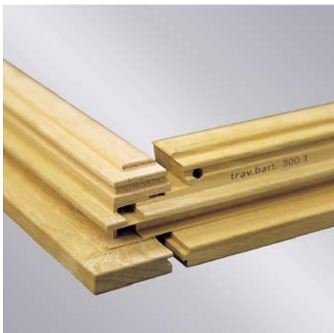
**La giunzione** tra montante e traversa del battente viene effettuata con doppio tenone a cava chiusa. Per l'incollaggio è utilizzata colla vinilica resistente all'acqua.
